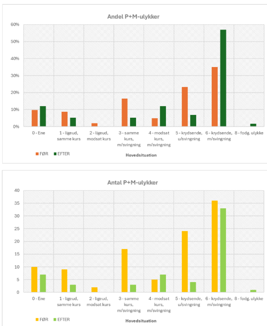
Figur 1. Andelen (øverst) og antallet (nederst) af ulykker fordelt på hovedsituationer før og efter ombygning af 59 vigepligtsregulerede F- og T-kryds.
