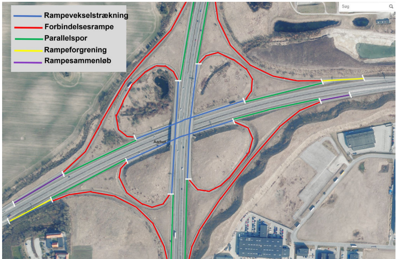
Figur 2. Strækningstyper som oftest findes i et motorvejskryds. Rampevekselstrækning (blå linjer), forbindelsesrampe (røde linjer), parallelspor (grønne linjer), rampeforgrening (gule linjer) samt rampesammenløb (lilla linjer).
