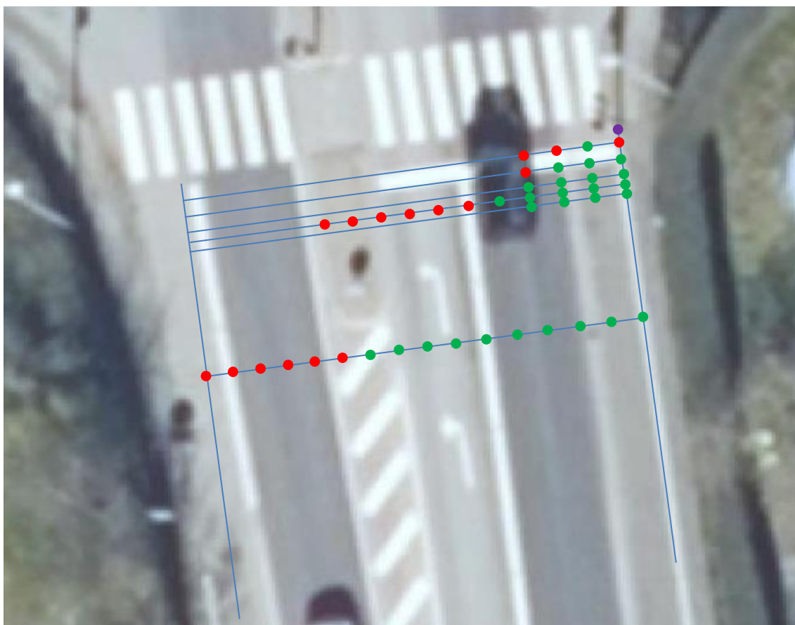
Figur 6. Angivelse af synlighed af lavtsiddende hovedsignal fra hhv. en bilists og en cyklists øjenhøjde på Bjerrevej (syd) i krydset Bjerrevej / Bankagervej / Jadevej. Røde prikker viser, at signal ikke kan ses, mens grønne prikker, at signal kan ses. Lilla prik angiver signalets placering. Luftfoto er fra Arealinformation.
