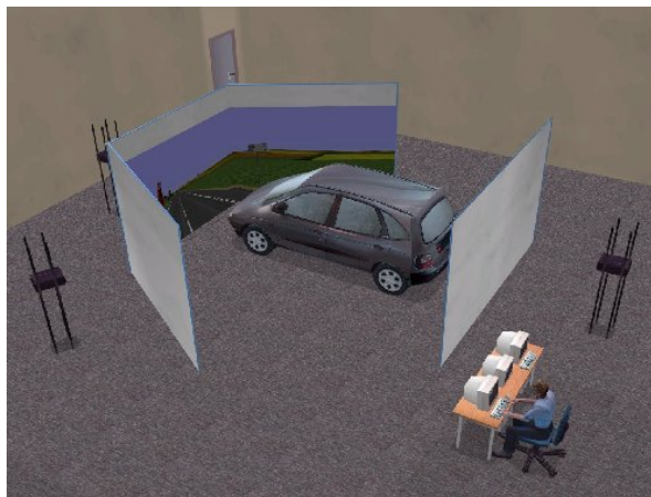
Figur 1. Forsøgsopstilling af køresimulator. Synsfeltet i simulatoren gør det muligt for forsøgspersonen at se vejmiljøet via forrude, bakspejl og sidespejle, samt i en vinkel på 45 grader til hver af siderne.
