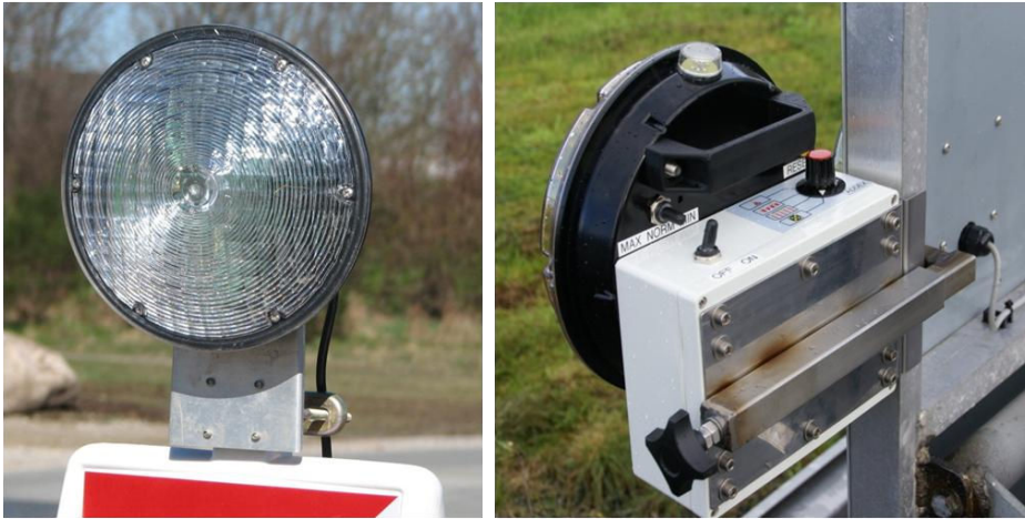
Figur 5: Referencelygte til kontrol af gule blink.
