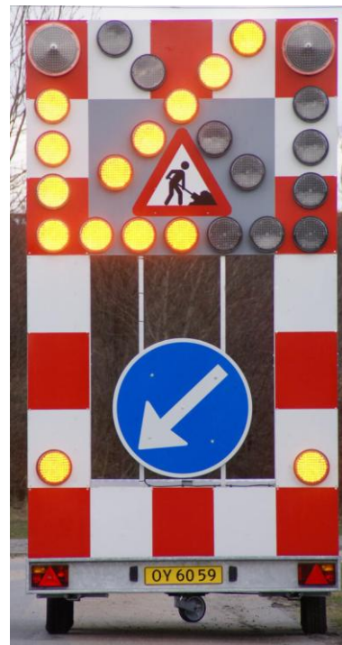
Figur 2B: Lyspil, Lukning af højre vognbane
