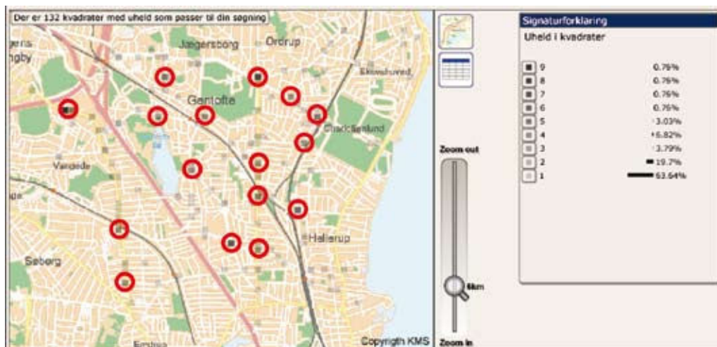
Figur 6: Krydsulykker i Gentofte Kommune 2002-2004 i kvadrater. De 17 mest ulykkesbelastede kvadrater er markeret med røde ringe.
