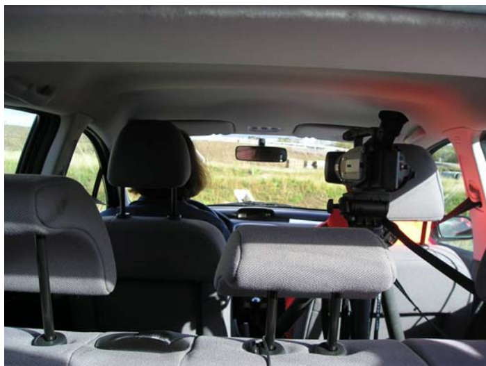
Figur 3. Placering af videokamera på bagsædet af bilen.
