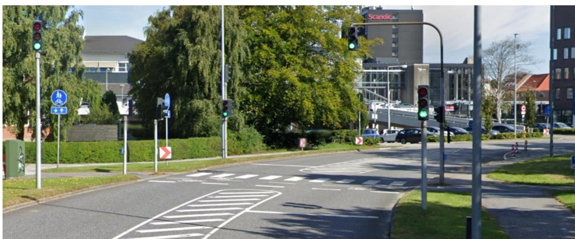
Figur 2. Tre forskellige reguleringer i vej-sti kryds. På øverste foto har stitrafikanter ubetinget vigepligt for vejtrafikanter. På fotoet i midten har vejtrafikanter ubetinget vigepligt for stitrafikanter. På nederste foto er vej-sti krydset signalreguleret.
