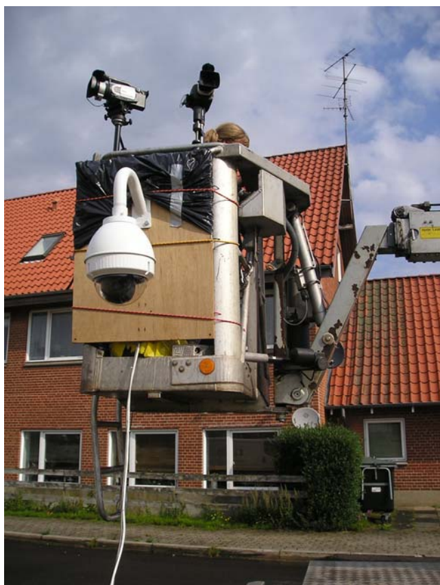
Foto 1: Liften med de tre kameraer der filmer rundkørslerne fra ca. 19 meters højde.
