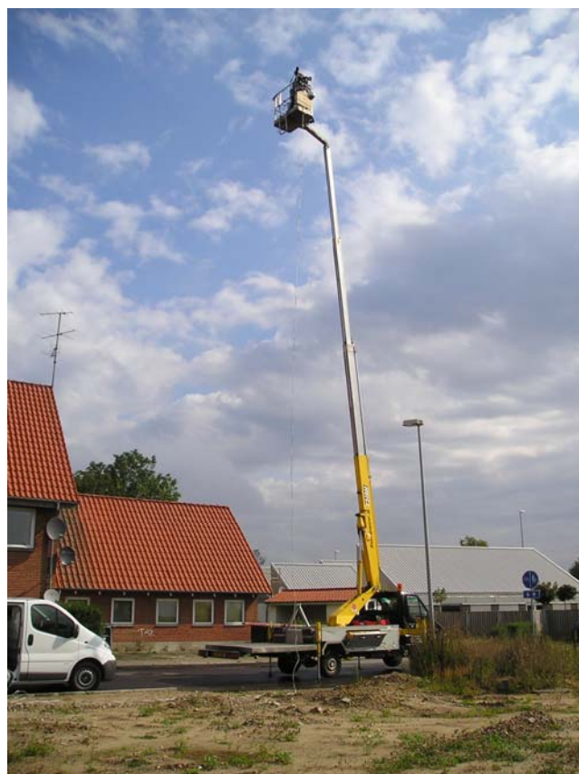
Foto 1: Liften med de tre kameraer der filmer rundkørslerne fra ca. 19 meters højde.
