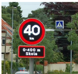
Figur 2.2: VMS tavle C55 med undertavle
