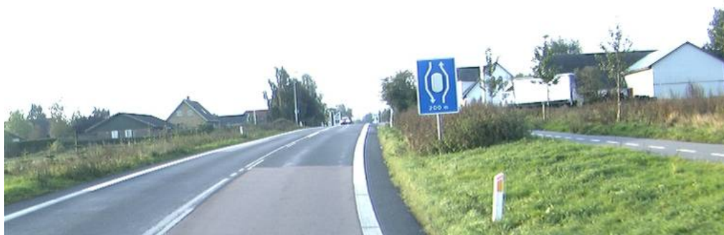
Forvarsling placeret i højre side i tilknytning til fysisk/visuel byport v/Ørbæk på Fyn.
