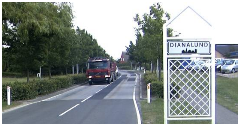
Foto 3.17 Byport i Dianalund. Byzonetavle på specialstander samt indsnævring af vejen vha. kantstensbegrænset bed med beplantning.
