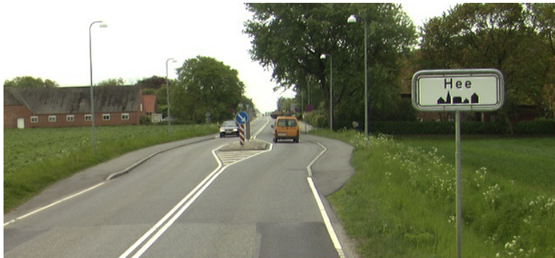
Foto 3.8 Byport i Hee. Byzonetavle på alm. stander samt helleanlæg og forsætning af kørespor i begge retninger – en såkaldt 'fuldmåne'.
