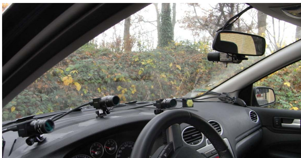
Figur 2.5 Målebilen er udstyret med et eyetracking system, der under kørslen registrerer, hvad bilistens blik er rettet mod. Udstyret består bl.a. af tre små infrarøde kameraer, der er placeret på instrumentbrættet, samt et scenekamera der videofilmer ud af forruden. Scenekameraet er placeret bag bakspejlet.
