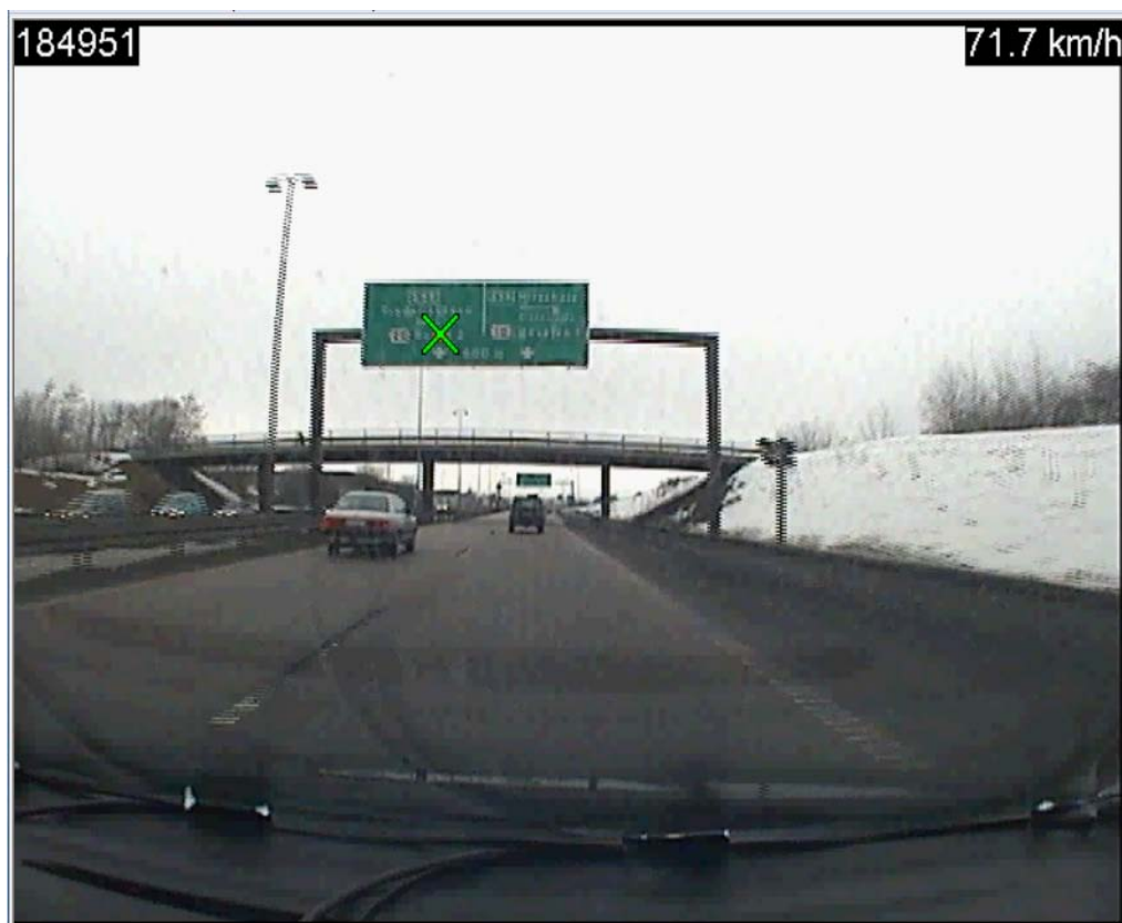
Figur 2.6 Det grønne kryds på portaltavlen (S5), angiver det sted testbilistens visuelle fokus er rettet mod (her S5 på forgretningsstrækningen). Tallet i øverste venstre hjørne refererer til data nr. i den tilhørende logfil. Tallet øverst til højre i billedet angiver bilistens aktuelle hastighed, som registreres vha. GPS.
