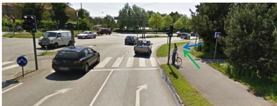
Figur 2. Højresvingsuheld højre om signal angivet med pile på gade-foto. Note: Blå pil er fodgænger og grøn pil er cykel. Kilde: Google maj 2009.
