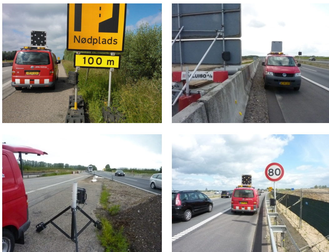
Figur 7: Eksempler på opsætning af radarboksen til måling af hastigheder på forskellige steder på de to interimsmotorveje.
