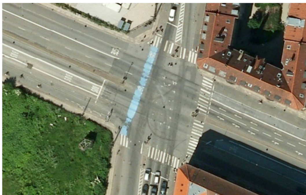
Figur 6: I dette kryds er stopstregen trukket tilbage i tre krydsben. I det ene af disse krydsben er der ikke et fodgængerfelt foran stopstregen.
