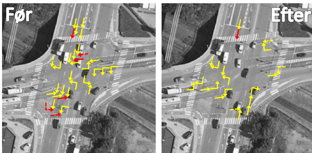
Figur 7. Kollisionsdiagram for før (til venstre) og efter periode for krydset Holstebrovej / Indre Ringvej. Note: Gul pil er element kun med materiel skade, rød pil er element med personskade, prikket pil er fodgænger, stiplet pil er cyklist / knallertkører, og fuldt optrukken pil er motorkøretøj.
