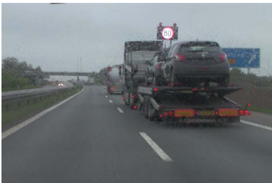
Figur 6. Foto af Høj tavlevogn set fra bilist i venstre spor med samtidig tungt køretøj i højre spor.
