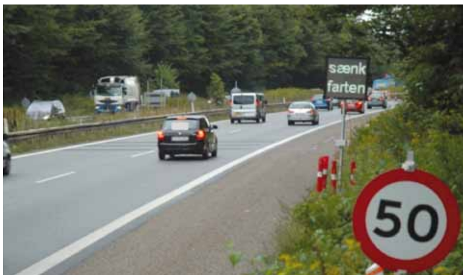
Figur 1. Hillerødmotorvejen. Den elektroniske tavle med budskabet SÆNK FARTEN er her placeret FØR rumlestriberne på strækning med skiltet 50 km/t. Foto: Trafitec.
