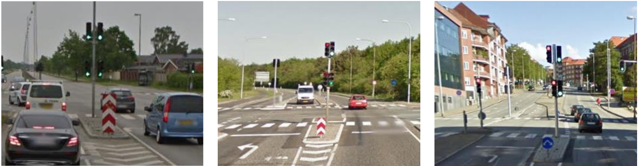
Figur 2: Venstre: N43-tavle med højde som personbil. Midt: lille N43-tavle. Højre: D16-tavle.
