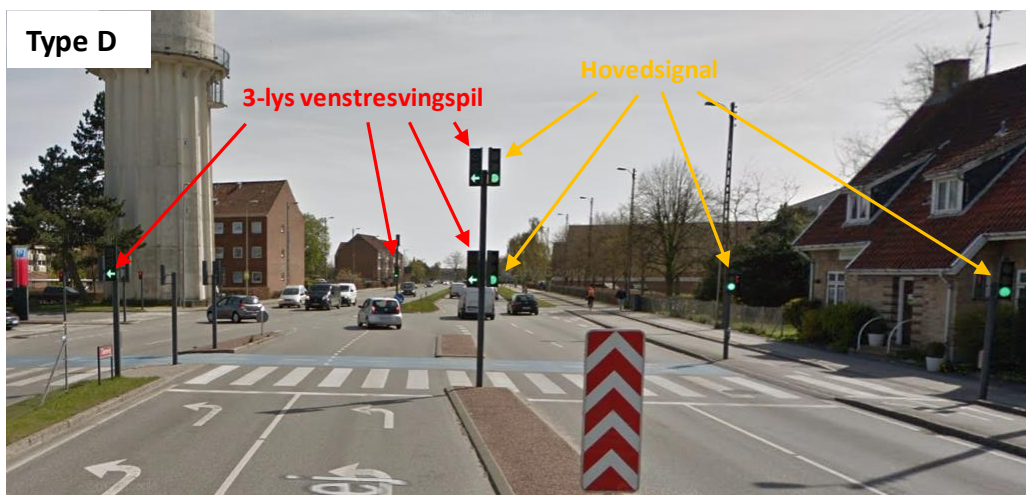
Type D: Hovedsignaler i krydsets forkant samt 3-lys venstresvingpile i krydsets for- og bagkant
