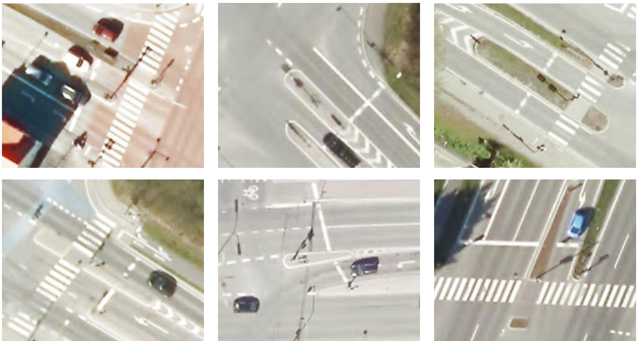
Figur 1: Størrelse, form og placering af deleheller i forhold til stoplinjer og fodgængerfelter kan variere en del. Nogle trekantede deleheller adskiller sig således kun i begrænset omfang fra de rektangulære. Øverst: 3 eksempler på rektangulære. Nederst: 3 eksempler på trekantede.
