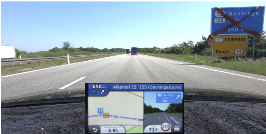
Figur 8. Gul tavle viser, at afkørselsrampe <15> er spærret, og man kan bruge <14> i stedet for. GPS viser i modstrid hermed, at man skal tage afkørsel <15> 650 m længere fremme.
