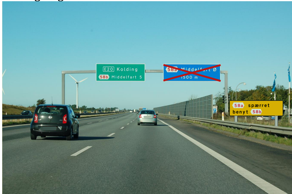
Figur 3.1: Visning 1 og 2 er identiske og viser en annulleret blå frakørselstavle placeret på motorvejsportalen og suppleret med en gul informationstavle placeret som jordtavle.
