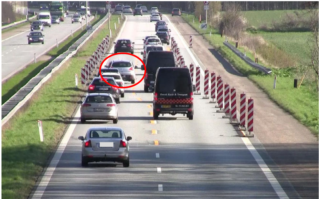
Figur 39: Den grå personbil er et eksempel på en trafikant, der kører på delelinjen på strækningen med smalle spor. Trafikanten kører tæt bag en forankørende, der har en sideværtsplacering mere til venstre i køresporet. Den grå bil passerer ingen trafikanter i højre spor på de 200 m.
