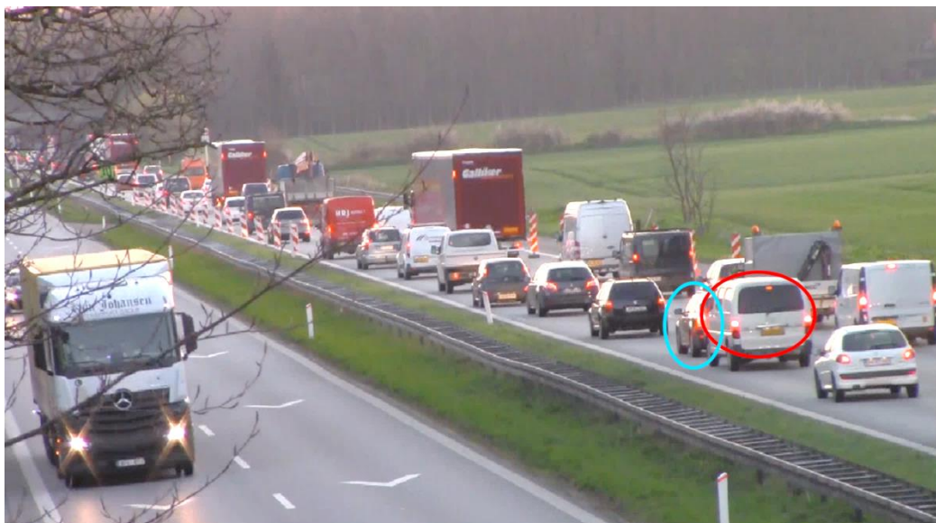
Figur 35: Biler i venstre spor kører meget tæt på hinanden frem mod og igennem vejarbejdszonen. Da PB (markeret med blå ring) bremser pga. kø, bremser bagvedkørende VB forholdsvis kraftigt for at undgå kollision. Også efterfølgende biler må bremse kraftigt.
