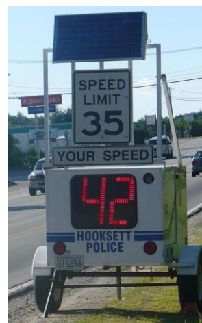
Figur 7.3: "Din Fart/Your Speed" vises på den digitale tavle sammen med den skiltede hastighedsgrænse, som her er 35 mph (56 km/t)
