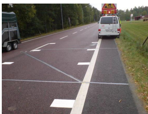
Figur 16.1: De optiske linjer er 30 cm lange og er påklisteret i begge sider vinkelret på køresporets sidelinjer. Foto til venstre er fra det svenske forsøg og foto til højre er fra et lignende forsøg i USA.
