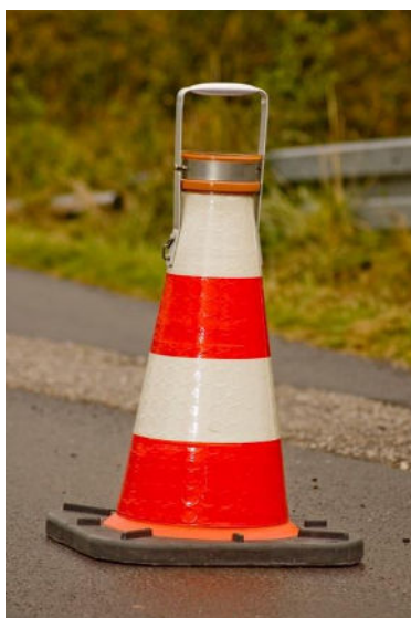
Figur 13.1: Trafikkegle med signalsender (transmitter). Signalet har en rækkevidde på 300-400 m. Advarslen kan sendes på en række forskellige sprog.
