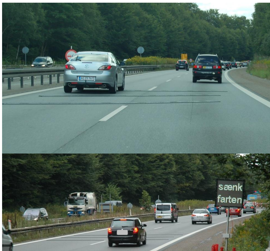
Figur 4.1: De mobile rumlestribes er udlagt alene (øverst) og i kombination med budskabet "Sænk Farten" vist på VMS-tavle ved for høje hastigheder (nederst).
