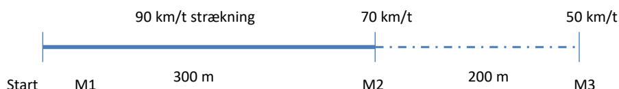
Figur 16.3: Principskitse for målestrækning med 3 hastighedsmålesnit. De optiske linjer er udlagt mellem M2 og M3.
