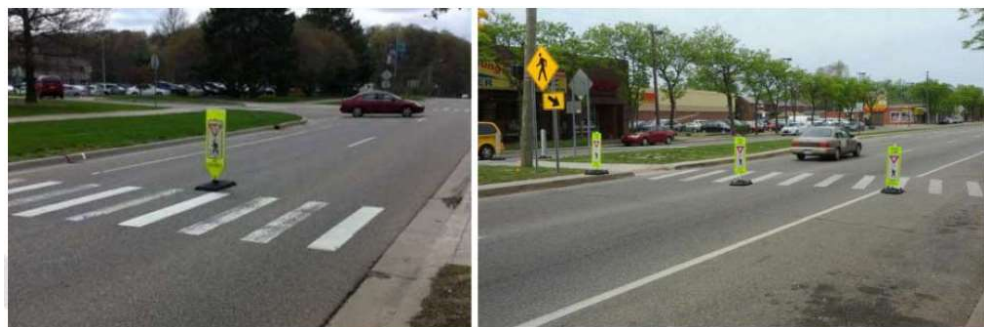
Figur 18: Lodrette markeringsskilte mellem kørespor – til højre med porteffekt, Michigan, USA. Versionen med porteffekt har den højeste andel af bilister, der viger for fodgængere (Bennett et al., 2014).
