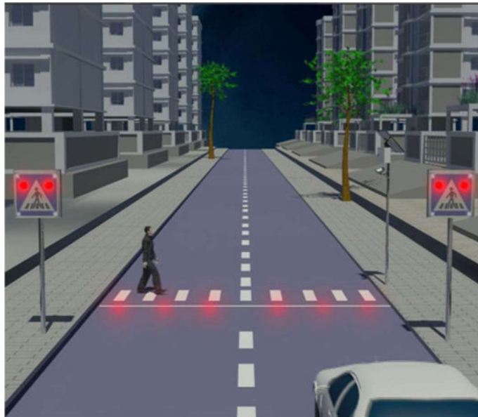
Figur 17: Kombination af rødt blinklys på tavle og langs fodgængerfelt ved fodgængers krydsning – principskitse.
