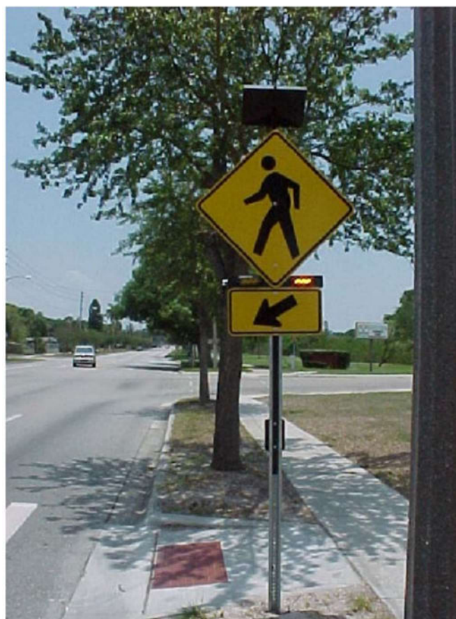
Figur 15: Tavle med fodgængeraktiveret gult blinkende lys, USA (Federal Highway Administration, 2010).
