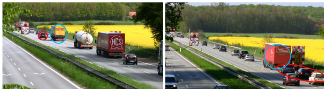
Figur 16: Til venstre eksempel på konfliktende adfærd mellem indflettende trafikant fra venstre spor (markeret med rød) og lastbil i det højre spor (markeret med blå). Til højre eksempel på konflikt i tæt trafik hvor trafikanter i højre spor (markeret med rød, der kører med for kort afstand til forankørende, må bremse kraftigt op for at undgå bagendekollision da forankørende LB (markeret med blå) bremser pga. kø.
