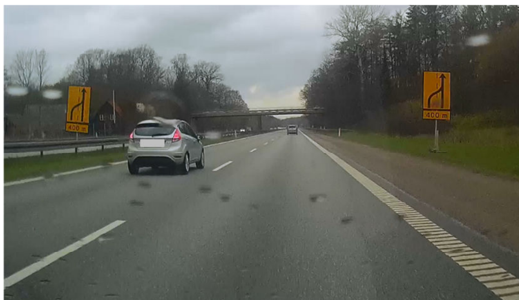
Figur 35: Indsnævringen til ét spor forvarsles 400 m før indsnævringsens start. Her MF016C.
