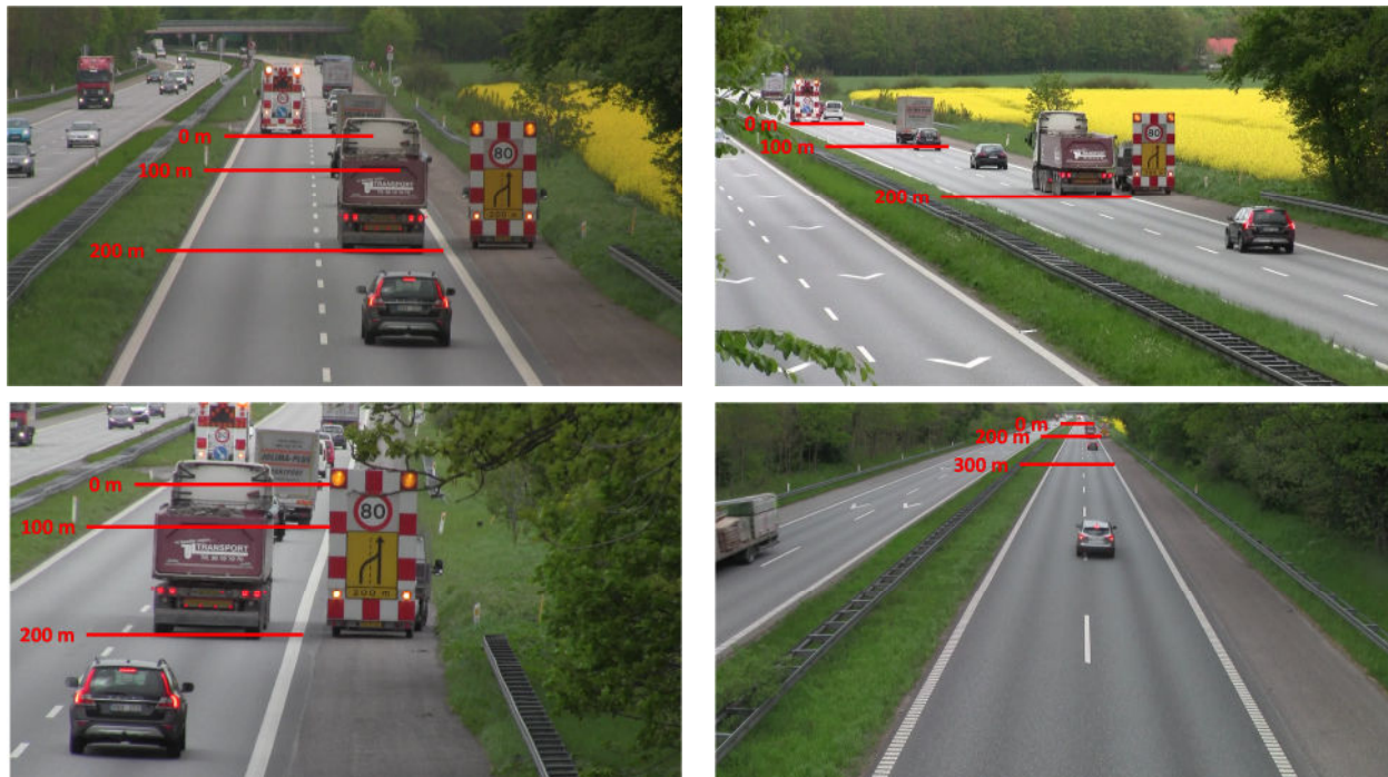
Figur 15: Udsnit af observationsfeltet fra hvert af de fire kameraer. Optagelserne i det nederste højre hjørne bruges til at observere strækningen 375-200 m før TMA, mens de øvrige benyttes til strækningen 250-0 m før TMA og stykket lige efter. Eksempel fra MF0202D.
