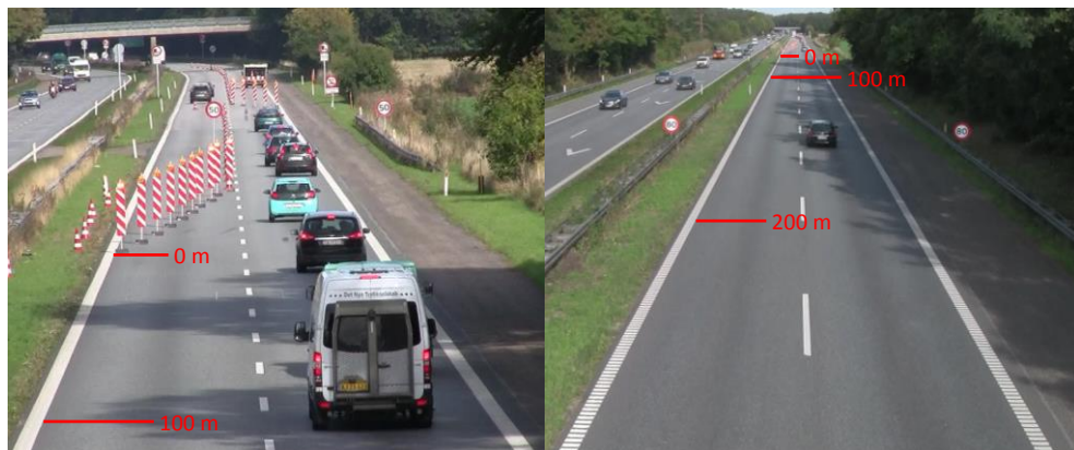
Figur 19: Eksempel på hvilken del af strækningen kameraerne dækker ved videoobservation (her MF016B). Trafikanterne filmes bagfra med mulighed for at se bremselys.
