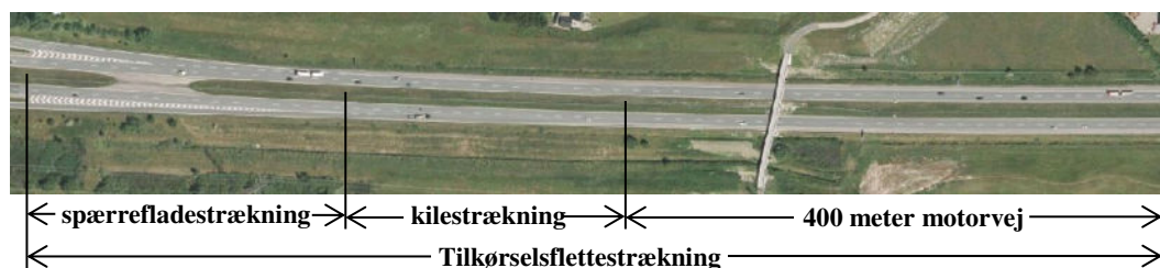
Figur 14. Illustration af ændret definition af tilkørselsflettestrækning.
