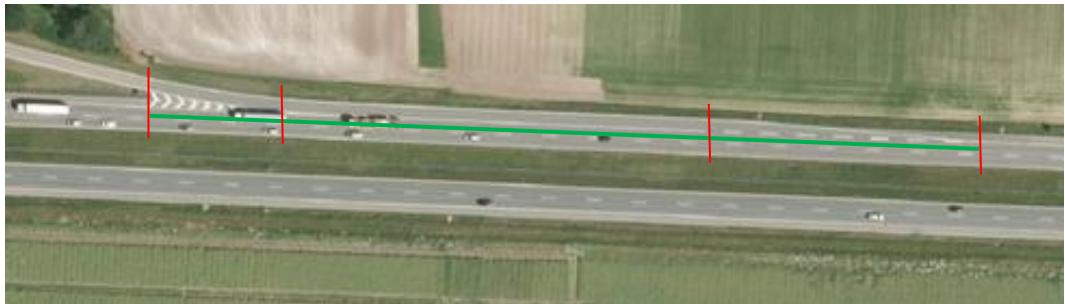
Figur 2. Frakørselsflettestrækning (grøn linje) med angivelse af kilometrerede punkter (røde linjer).
