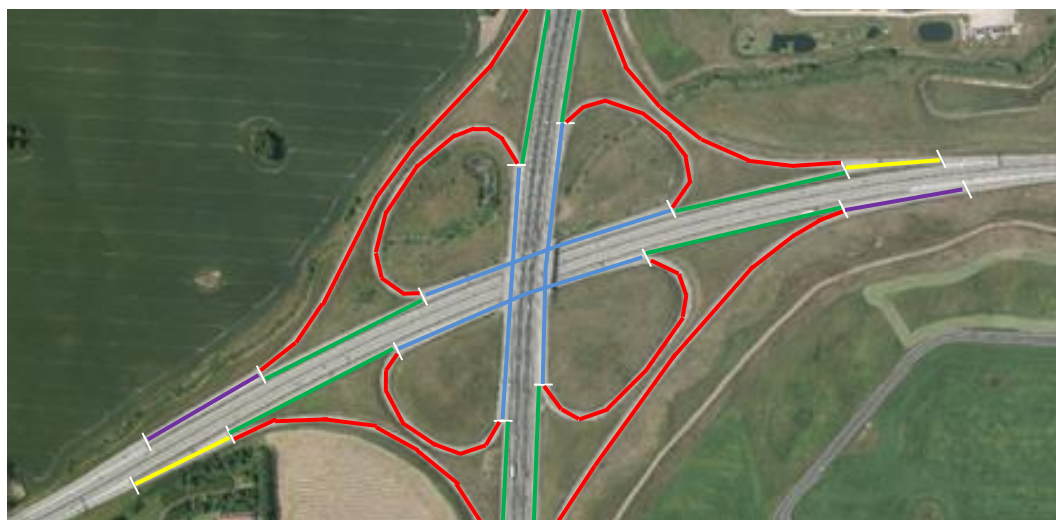
Figur 3. Motorvejskryds med angivelse af de undertyper af ramper. Røde linjer = forbindelsesramper. Blå linjer = rampevekselsestrækning. Grønne linjer = parallelspor. Gule linjer = rampeforgrening. Lilla linjer = rampesammenløb.
