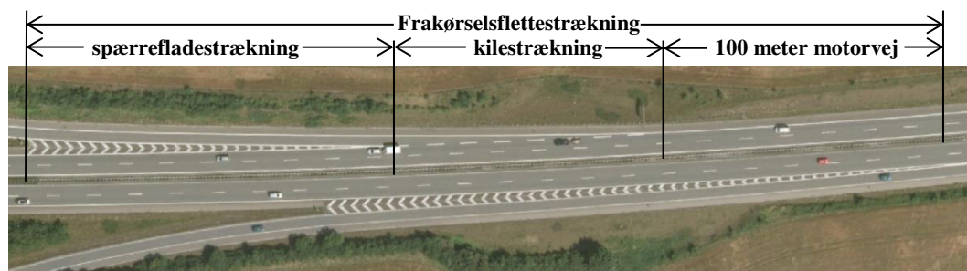
Figur 13. Illustration af ændret definition af frakørselsflettestrækning.
