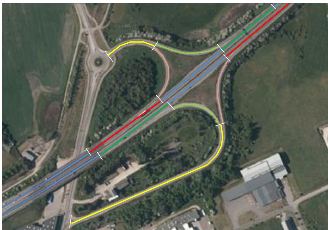
Figur 1. Nogle hoved- og undertyper af motorvejsnettet. Blå linjer = almindelig motorvejsstrækning. Grønne linjer = frakørselsflettestrækninger. Lysegrønne linjer = frakørselsramper. Røde linjer = tilkørselsflettestrækninger. Lyserøde linjer = tilkørselsramper. Gule linjer = dobbeltrettede ramper.
