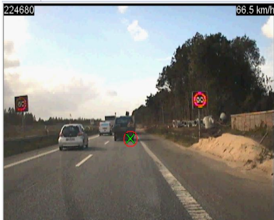
Eksempel på scenekameraets videobillede med angivelse af testbilistens blikretning (grønt kryds med rød cirkel omkring). Øverst til højre i billedet ses testbilistens hastighed. Tallet øverst til venstre i billedet angiver videobilledets framenummer.
