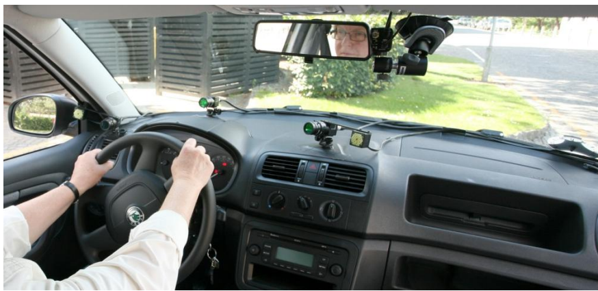
De tre kameraers placering på instrumentbrættet; til højre, venstre og midt for testbilisten. Scenekameraet ses bag bakspejlet. Foto: Kasper Erling, Skoda.
