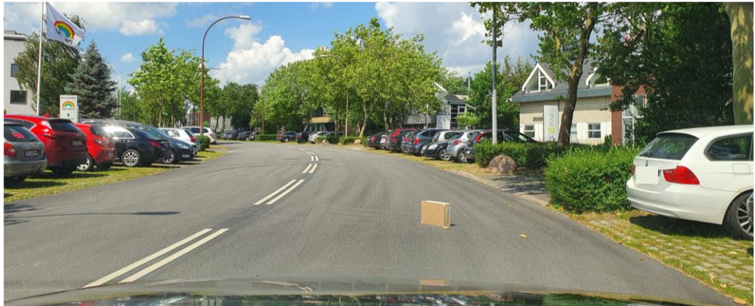
Figur 8. Trafikant skal foretage en hurtig undvigemanøvre for at undgå påkørsel af tabt gods. Reaktion ved en uventet hændelse er erfaringsmæssigt 2,5-2,7 sek. (foto: Trafitec).
