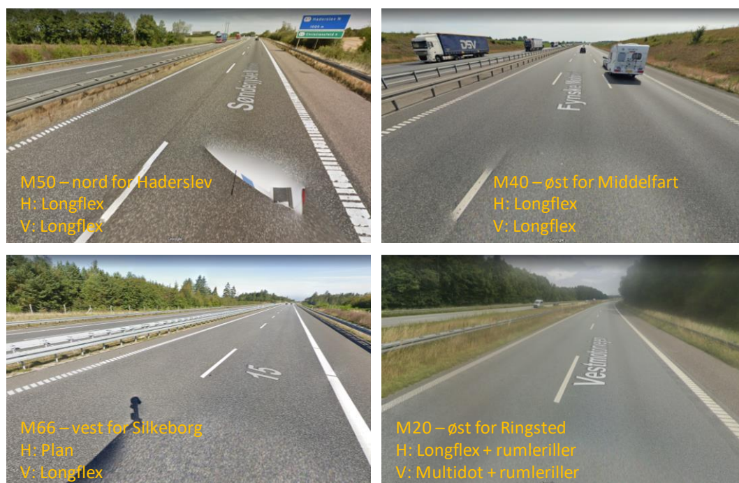
Figur 5: Eksempler i Danmark på længdeafmærkning på motorvej >1 km til by og flere hundrede meter til nærmeste beboelse, undtagen nederst til højre, hvor der er >500 m til by, (Google Street View).
