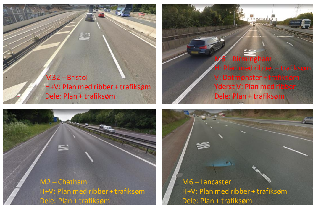
Figur 11: Eksempler i Storbritannien (venstrekørsel) på længdeafmærkning på motorvej <100 m fra by, undtagen eksemplet nederst til højre med 100-150 m fra by. På eksemplet øverst til højre er der vejbelysning og mulighed for kørsel i nødspor (Google Street View).
