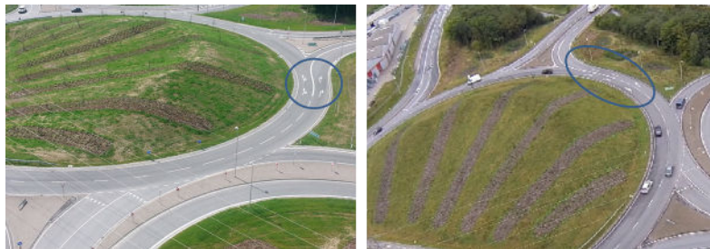
Figur 2. Foto til venstre: Forholdsvis mange trafikanter erkender først sent i førperioden, at de kører i et tvungent højre spor (rød stiplede linje). For at fortsætte videre rundt i rundkørslen foretager trafikanterne derfor et sent uhensigtsmæssigt vognbaneskift mod venstre over fuldt optrukket linje. Foto til højre: Problemet blev afhjulpet ved at forstærke afmærkningen med et tredje sæt pile (blå ring) samt tydeliggørelse af vejvisningen ved kørsel frem mod rundkørslen.
