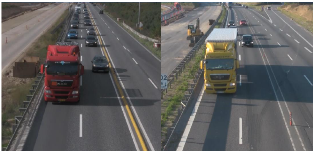
Figur 60: Foto til venstre viser midteradskillelse med gul bjælke og foto til højre viser en mindre fysisk adskillelse med steler mellem modsatrettet trafik.
