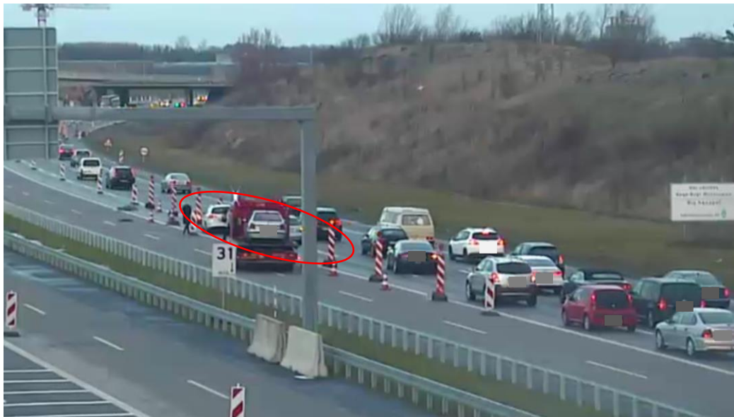
Figur 19: Sporbortfald markeret i et svagt kurveforløb. Sporbortfaldet vurderes at ske over en for kort strækning og ikke at være tilstrækkelig tydeliggjort. Den røde ring markerer ulykkesstedet.
