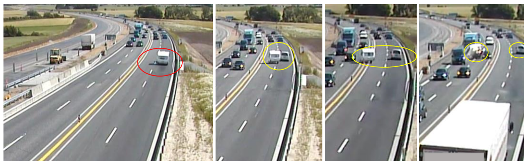
Figur 41: Lunke eller forhøjning i vejens højre spor ved overføring af motorvej bevirker, at campingvogn løsner sig fra træk, fortsætter hen over gul bjælke og ender i modsatrettet kørebanelhalvdel. Den røde ring markerer køretøjet og lokaliteten med lunke, mens de gule ringe markerer køretøj og campingvogn efter at denne har løsnet sig.
