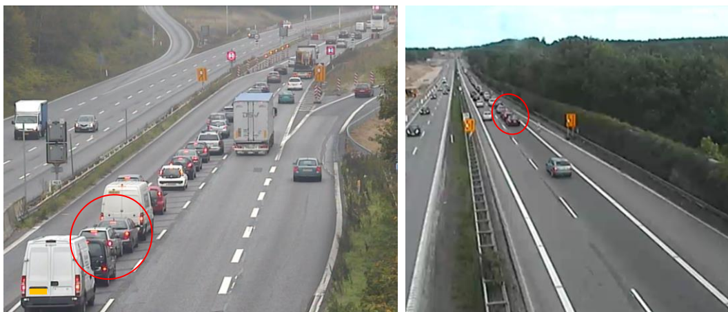
Figur 23: Bagendekollisioner opstrøms sporbortfald. Til venstre ses eksempel på sporbortfald fra venstre 3 →2 spor, mens foto til højre illustrerer eksempel med sporbortfald fra venstre 2 →1 spor. Ulykken til højre sker så langt opstrøms sporbortfaldet, at sporbortfaldet ikke kan ses på foto. Røde ringe markerer de ulykkesinvolverede.
