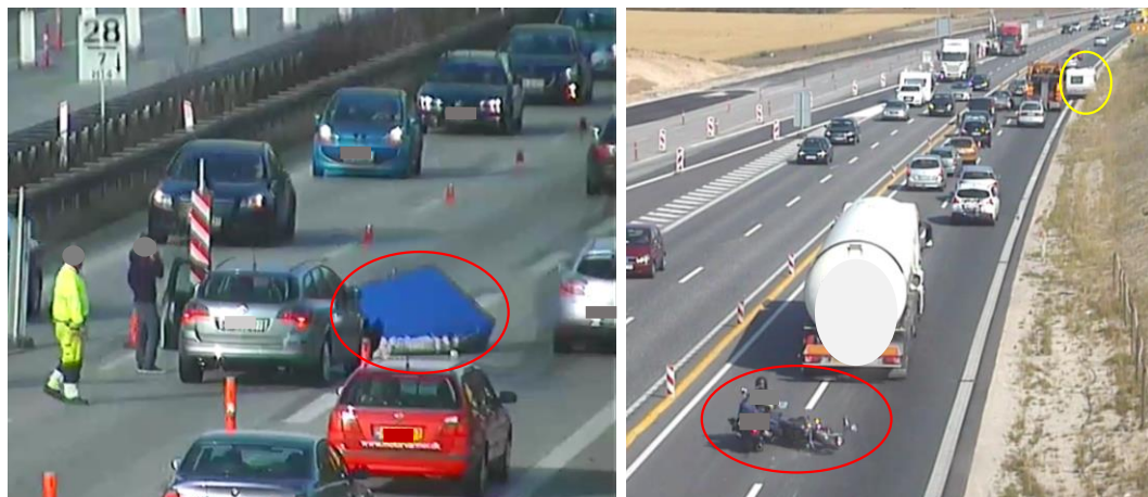
Figur 45: Venstre foto: Trailer (markeret med rød ring) har krydset midteradskillelsen, bestående af vognbanelinjer og små faner pr. 15m, og er blevet påkørt af modkørende personbil. Bemærk, at keglene mellem spor 1 og 2 først er sat ud til afspærring af spor 2 efter ulykken. Højre foto: Bilist med campingvogn (markeret med gul ring) gør ophold i vejsiden/højre spor, hvilket er medvirkende årsag til at to motorcyklister (markeret med rød ring) forulykker.
