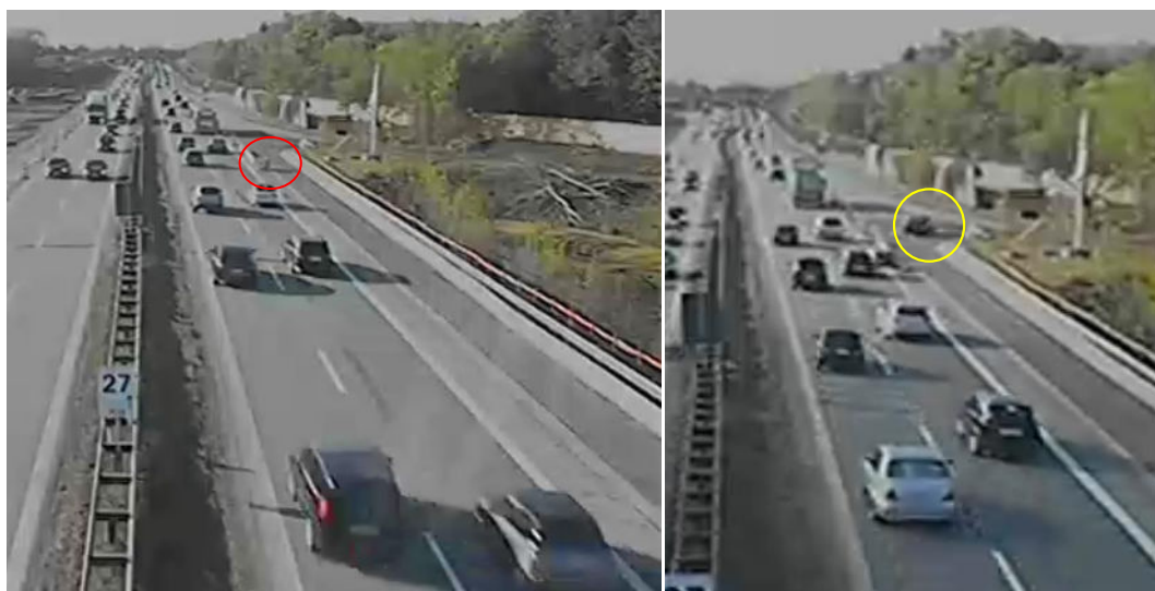
Figur 46: Venstre foto: Den røde ring markerer indgangen til vejarbejdsområdet og dæk placeret foran trafikværn. Bemærk i øvrigt, at der er "fri adgang" til den vognbane, som fører ind til vejarbejdsområdet. Højre foto: Én af de ulykkesinvolverede bilister (markeret med gul ring) der er kommet ind i vejarbejdsområdet.
