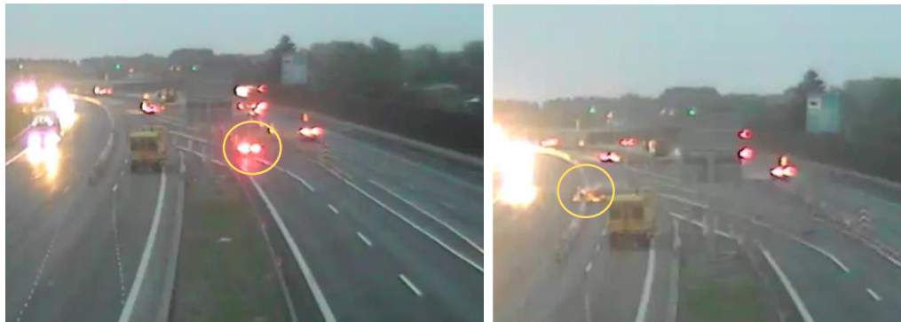
Figur 32: Trafikant fra spor 4 kører med høj hastighed frem mod forgrening og overledning af spor 3 og 4. Den gule ring markerer trafikanten. Til højre ses påkørsel af flytbart trafikværn.
