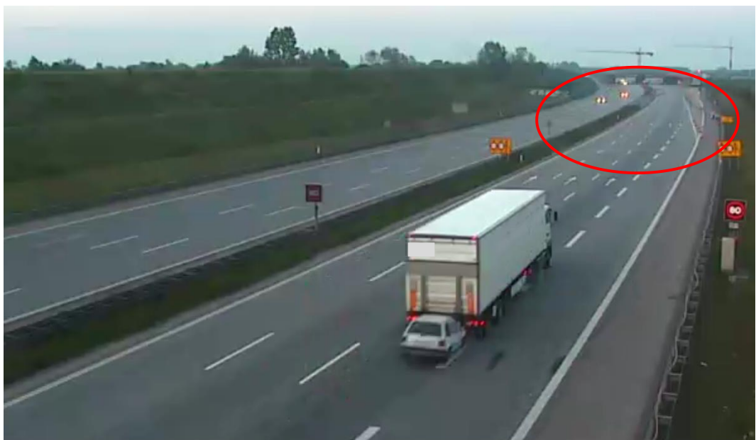
Figur 22: Lastbilchauffør foretager vognbaneskift til venstre forud for sporbortfald (markeret med rød ring) og påkøres af bagfrakommende bilist.
