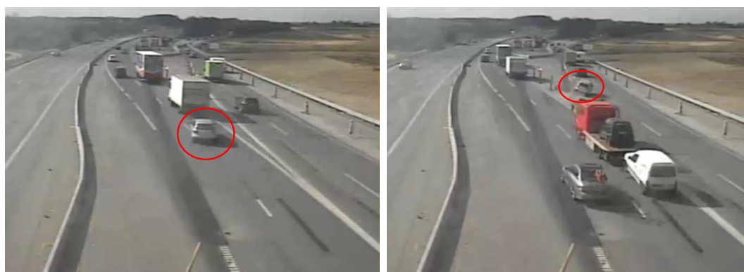
Figur 28: Én af de to ovenfor beskrevne eneulykker, hvor en bilist bevidst skifter fra venstre vognbane i venstre vejgren krydser spærrefladen i retning mod højre vejgren - og forulykker. Røde ringe markerer den ulykkesinvolverede.
