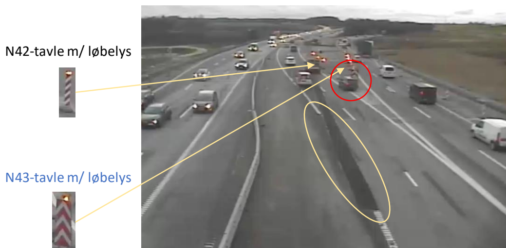
Figur 25: S-kurven (svær at fornemme) er uhensigtsmæssig placeret i en højresvingskurve og er ikke synliggjort ved N42-tavler langs kantlinje. Kantlinje mangler delvist i S-kurvens venstre side (markeret med gul ring). Den røde ring markerer den forulykkede bilist.
