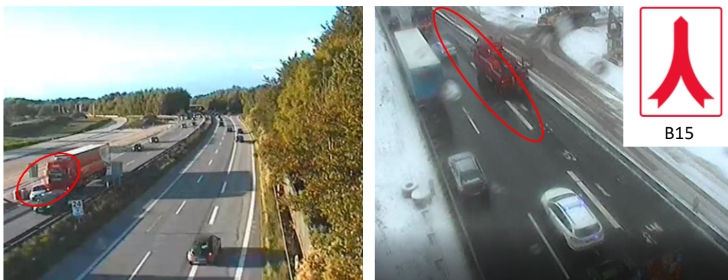
Figur 36: Venstre foto: Den røde ring markerer den ulykkesinvolveret rampebilist, som har været beliggende foran lastbilen på motorvejen. Højre foto: Den røde ring markerer afmærkningen for enden af rampen, som indikerer regel om vognbaneskift ved indfletning, hvilket ikke synes at være entydigt med skiltningen nedstrøms mellem rampe og motorvej (B15 tavle om fletteregel).
