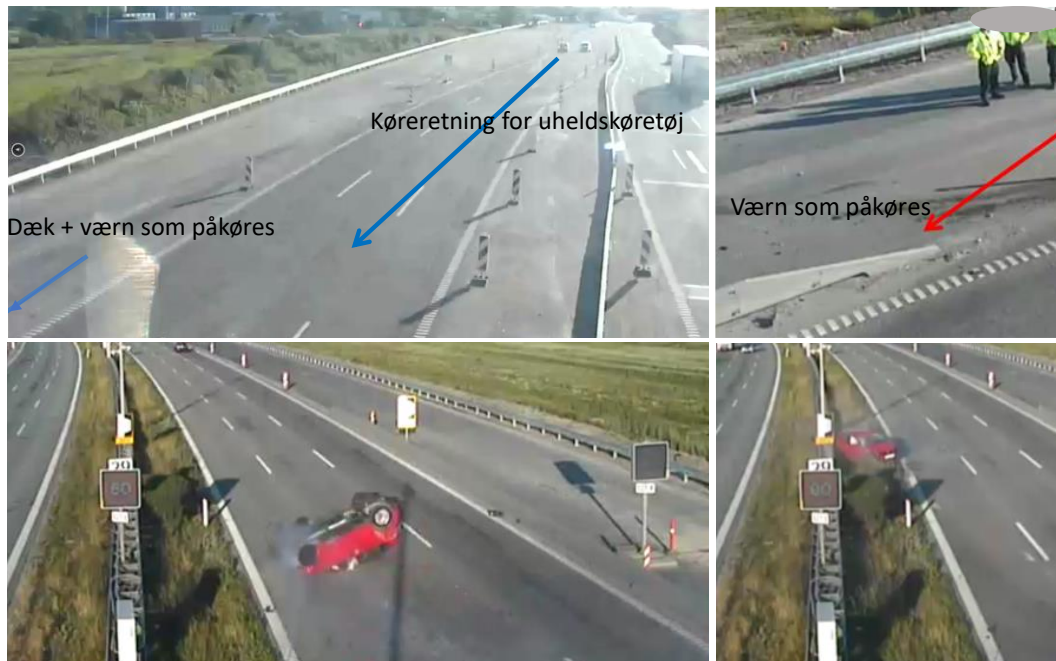
Figur 16: Øverst: S-kurve placeret i blød venstresvingskurve. Pile markerer bilistens køretretning og angiver placering af dæk og værn, som bilisten påkører. Påkørsel af dæk og værn vurderes at have været ulykkesforværende. Nederst ses det forulykkede køretøj.
