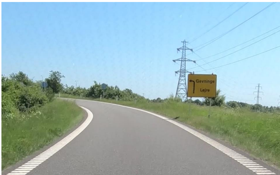
B1.10: Midlertidig gul tavle på frakørselsrampe <14> viser at man skal dreje til venstre for enden af rampen for at følge omkørsels-vejvisningen til Gevninge.
