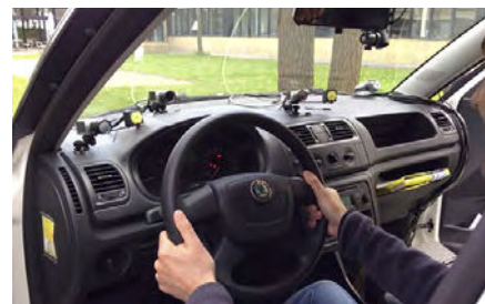
Figur 2. Smart Eye Pro kamerasystem monteret i Trafitecs målebil. Øverst på instrumentbrættet ses de tre eye track kameraer, mens selve scenekameraet, der filmer det, som føreren ser ud af forruden, er monteret bag bakspejlet.
