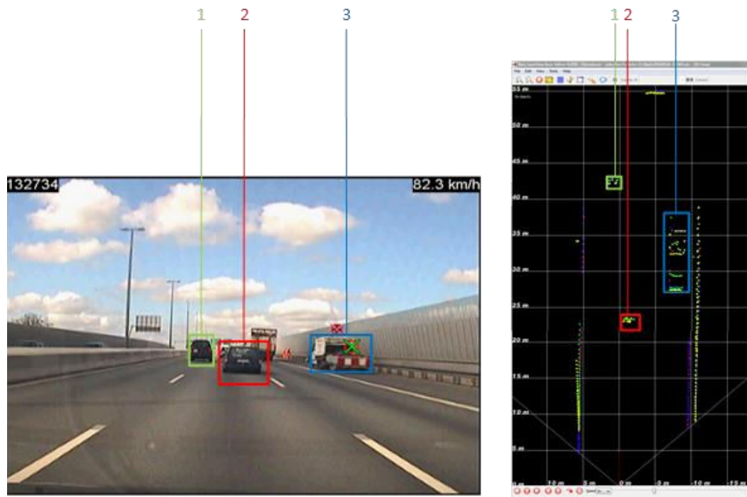
Figur 3.3: Eksempel på scenekameraets billede vises til venstre. Til højre ses laserscannerens gengivelse af samme trafiksituation
