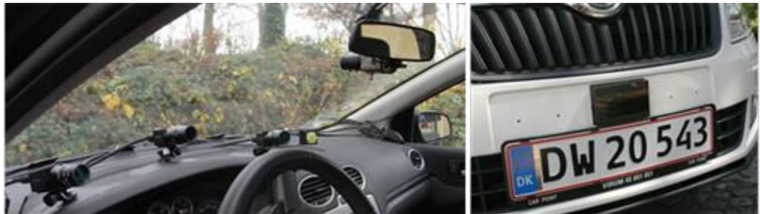
Figur 3.1: Smart Eye kamerasystem monteret på instrumentbræt og suppleret med scenekamera monteret bag bakspejlet vist til venstre. Laserscanner monteret på bilens udvendige frontpanel ses til højre.
