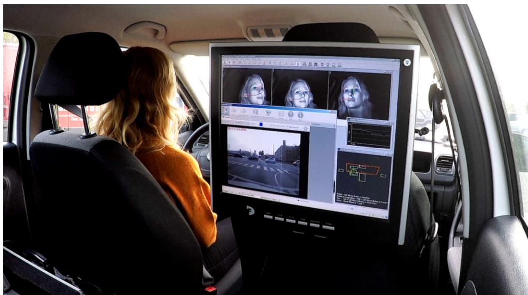
Figur 3.2: Screenshot fra bagsædekamera. På PC-skærmen ses billede fra hver af de tre eye-track kameraer (øverst), fra scenekameraet (nederst til venstre) samt en 3-dimensionel figur af bilens forrude, instrumentbræt og spejle (nederst til højre).
