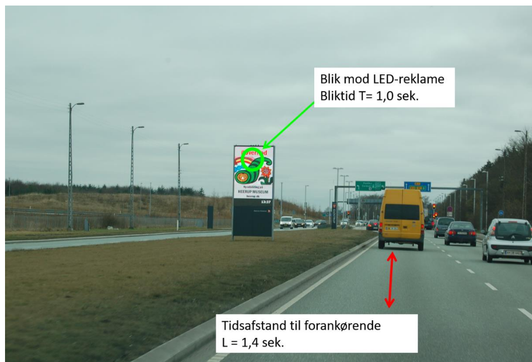
Figur 6.1: Eksempel på LED-reklameblik (bliktid= 1,0 sek.) samtidig med et forankørende køretøj inden for relativ kort tidsafstand (tidsafstand 1,4 sek.). I det viste eksempel er sikkerhedsbufferen 0,4 sek.
