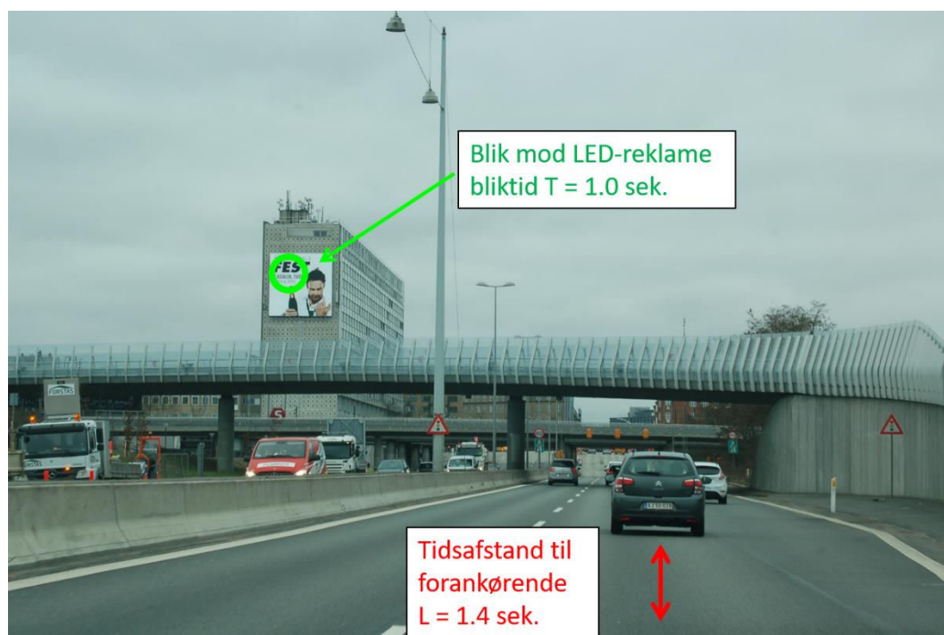
Figur 3.5: Med en bliktid på 1,0 sek. og en tidsafstand til forankørende på 1,4 sek. er sikkerhedsbufferen 0,4 sek.
