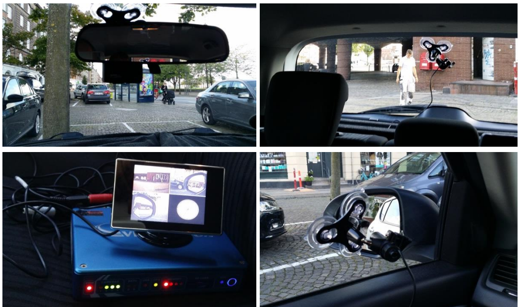
Figur 1. Øverst til venstre er GoPro kamera placeret bag bakspejl, øverst til højre er VBOX kamera placeret i bagrude, nederst til højre er VBOX system med skærm og nederst til venstre er VBOX kamera placeret i venstre forreste siderude.
