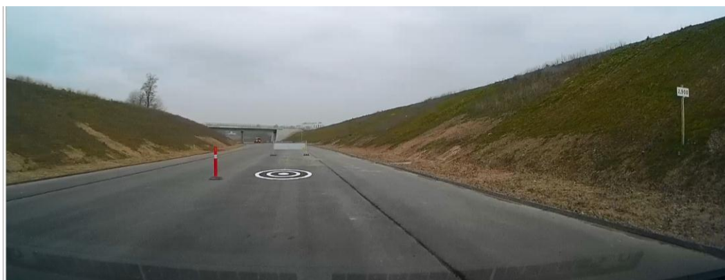
Figur 4.31: Centrumsymbolet med symbolhøjde 5,0 m
