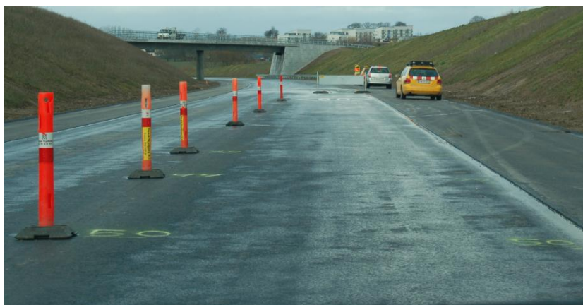
Figur 2.1: Testbane med keglemarkering af afstandsmål til symbolet.
