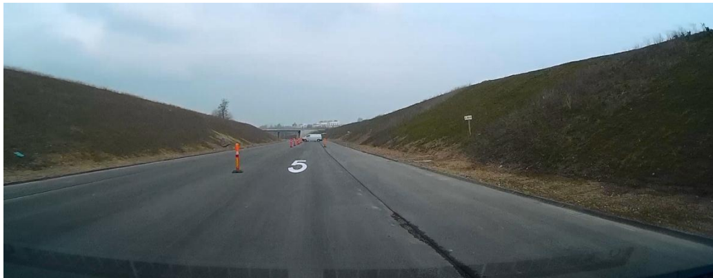
Figur 4.33: Tallet "5" med symbolhøjden 9,0 m.
