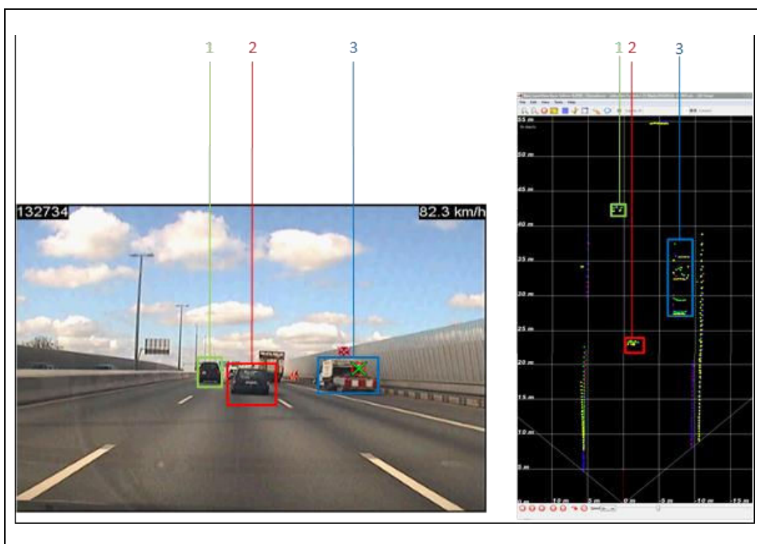
Figur 2.3: Eksempel på et laserscanner track. Trafiksituationen registreret med scenekamera ses til venstre og samme trafiksituation registreret med laserscanneren ses til højre.
