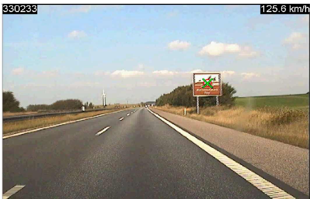
Figur 2.2: Eksempel på scenekameraets billede. Det grønne kryds med den røde ring omkring angiver førerens blikretning.
